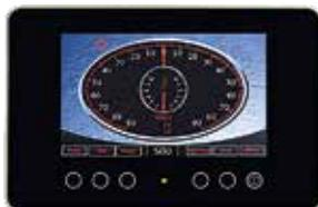
Standaard voorzien van volledige software, met roerindicatie, dieptemeting, wind, kompas, autopiloten en bochtaanwijzer visualisering. De instrumenten worden allemaal software matig gecreëerd, dus de Falcon F100, F120, F130, F300, F345, F345TMC en de meeste andere zichtinstrumenten worden weergeven op het beeldscherm van het Falcon multifunctionele zichtinstrument. Het biedt een enorme flexibiliteit ten aanzien van kleur, lay out, taal, enz.
