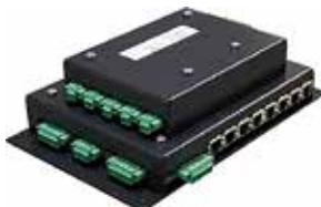
De Falcon multiHUB verdeelt en concentreert dataverkeer over een schip. De multiHUB werkt met ethernet, NMEA0183 en NMEA2000 signalen. De multiHUB zorgt voor het multiplexen van diverse signalen en geeft signalen van een lager niveau (NMEA) door aan hogere communicatieniveaus (ethernet). De multiHUB is hiervoor ontworpen volgens de IEC60945 norm.
