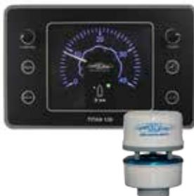
De TITAN-130 is een indicator voor de windsnelheid en windrichting. De windsnelheid wordt weergegeven op een analoge indicator. De windsnelheid kan ook digitaal worden weergegeven en kan worden ingesteld op m/sec of Beaufort. Het OLED-display geeft informatie over de windrichting. De sensor van de TITAN-130 bevat geen bewegende onderdelen, waardoor het een betrouwbaar en duurzaam product is.
