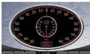
Het pakket wordt gevormd door de F551 weg-afhankelijke en rivierpiloot hendel, een aansluitkast, smart-gyro met 90/300 graden overschakeling en de slimme roerstandgever. Binnen het Falcon netwerk, levert de Falcon 550 wegafhankelijke en rivierpiloot functionaliteit. Standaard voorzien van volledige software, met roerindicatie, dieptemeting, wind, kompas, autopiloten en bochtaanwijzer visualisering.
